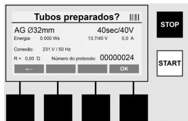
Após a introdução de dados bem sucedida, o ecrã muda para a pergunta sobre se os tubos são processados de acordo com os dados do fabricante. Isto tem de ser confirmado com >**OK**<.
