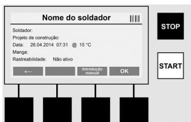
No menu >SOLDADURA< é possível introduzir os dados necessários para a soldadura. Para isso, é possível detetar um código de barras com o scanner de código de barras ou opcionalmente também manualmente com as teclas multifunções.
