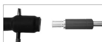
Instalar o novo adaptador manualmente e aparafusar até ao batente e fixar com chave de fendas Torx 15 (15Nm) e, de seguida, remover novamente o pino de fixação.
