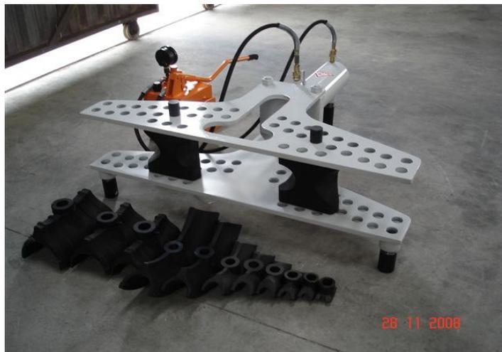
Devido as suas características simples, de fácil manejo, é o equipamento ideal em operação de curvatura nas empresas de montagens, construções, estalerios, instalações e hidráulicas, com essas características peculiares (cilindro hidráulico de grande diâmetro), não recomendamos que seu acionamento seja feito por bomba manual, porém, pode ser uma alternativa de acionamento.
