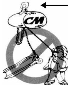
Certifique-se de que a carga esteja fixada com segurança. Não prenda a carga na ponta do gancho. Não coloque a carga na trava de segurança. A trava serve para evitar que a carga se solte quando a corrente não está esticada.
