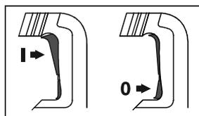
Para a **colocação em funcionamento** da ferramenta eléctrica deverá premir o interruptor de ligar-desligar **4** na parte de cima (**I**), até travar.
