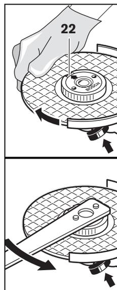
Premir a tecla de bloqueio do veio **2** para imobilizar o veio de rectificação. Girar o disco abrasivo fortemente no sentido dos ponteiros do relógio para apertar a porca de aperto rápido.
