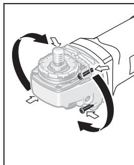
O cabeçote de engrenagens pode ser girado em passos de 90°. Desta forma é possível colocar o interruptor de ligar-desligar numa posição mais propícia para certos trabalhos especiais, p. ex. para trabalhos de corte com a capa de aspiração com carril de guia 20/coluna para corte ou para esquadros.
