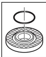
No flange de admissão **8** encontra-se uma peça de plástico (o-ring) em volta do colar de centragem. **Se o o-ring estiver faltando ou estiver danificado, será imprescindível substituí-lo (número de produto 1 600 210 039), antes de montar o flange de admissão 8.**
