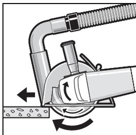
Ligar a ferramenta eléctrica e colocá-la com a parte dianteira do carril de guia sobre a peça a ser trabalhada. Empurrar a ferramenta eléctrica com avanço moderado, adequado ao material a ser trabalho.
