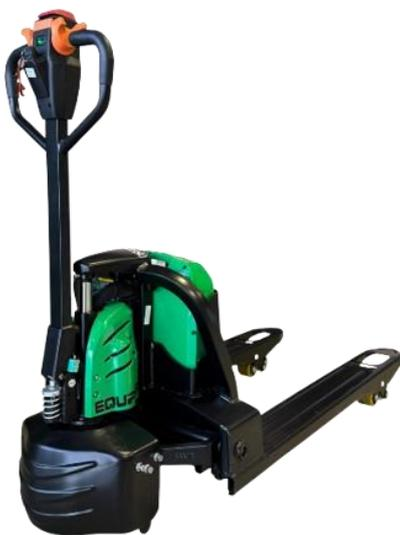
As Transpaleteiras elétricas com bateria de lítio são equipamentos utilizados para o transporte de cargas em ambientes industriais, como depósitos, armazéns e centros de distribuição. Nosso equipamento é capaz de suportar cargas de até 2,0 toneladas.
